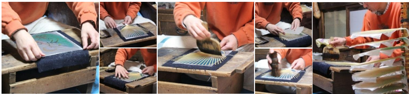
真竹でつくった骨に糊づけ。叩き刷毛を使い密着させていく紙貼りの作業
